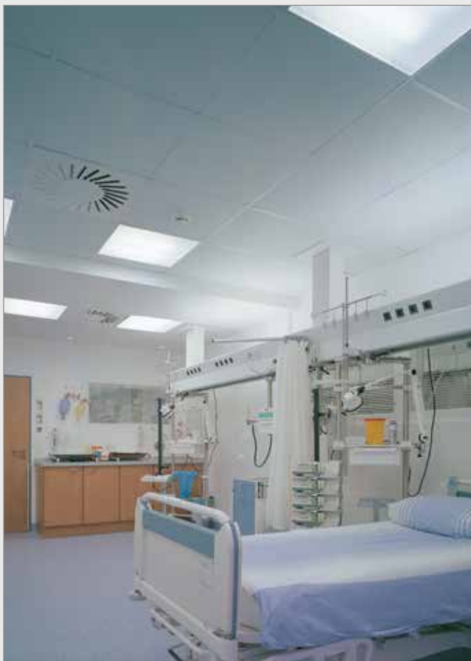
سقف کاذب مقاوم در برابر قارچ و باکتری (Hygiene)
